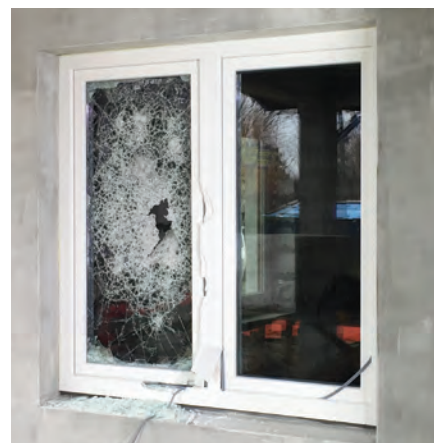
Испытания антивандального окна SOLWIN в ноябре 2017 года. Профильная система VEKA SOFTLINE 82, фурнитура WINKHAUS, стеклопакет Glas Trösch. Взломщик не смог открыть окно, в течение 20 минут. Объект – коттедж в Киевской области
