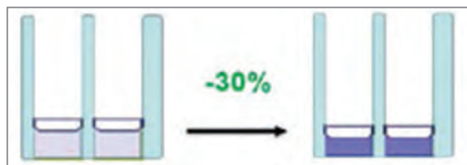
Использование DOWSIL 3363® позволяет до 30% уменьшить глубину герметизации стеклопакета
