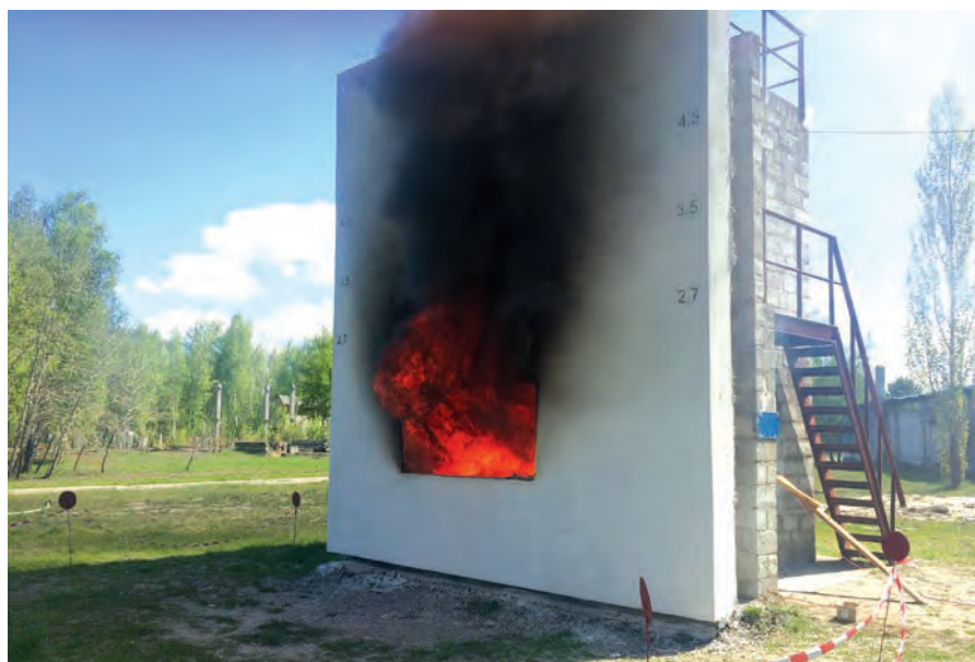
Фото 3. Випробування на поширення вогню системи утеплення Ceresit Ceretherm Classic. 2017 рік.
