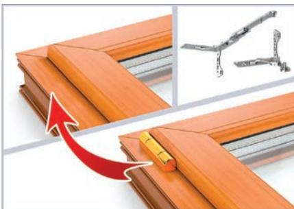
підвищується герметичність і енергоефективність віконної конструкції. Приховані петлі не переривають контур ущільнювача вікна (контур залишається замкнутим), що виключає продування і промерзання в петльовій зоні.
