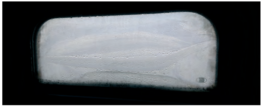
Запотівання склопакета в купе залізничного вагона. Приклад застосування склопакета з недостатніми теплотехнічними властивостями
