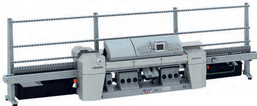
Лінійний кромкувальний верстат Bavelloni VE500
